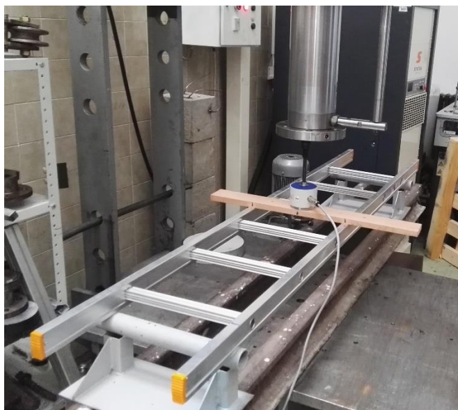
Слика 10 Мерење угиба дејством силе на средини распона у чеоном правцу мердевина
