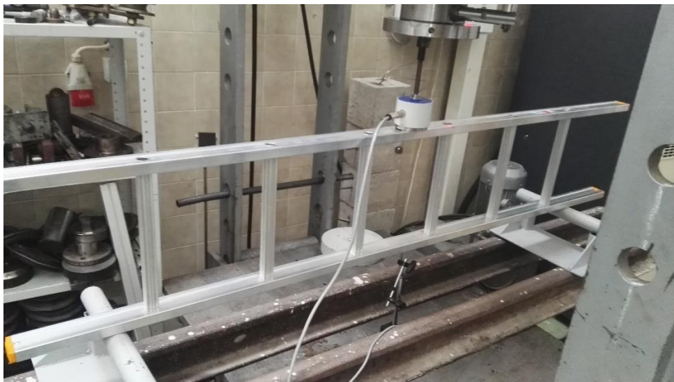
Слика 8. Мерење угиба у бочном правцу меревина
