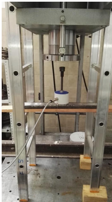
Слика 4. Фотографија са мерења оптерећењем на средини газишта
