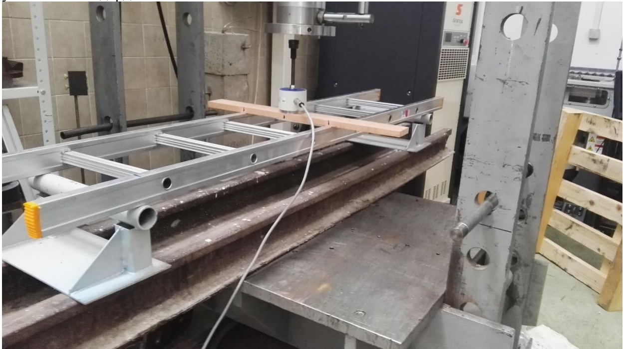
Слика 2 Конфигурација мерења носивости мердевина
