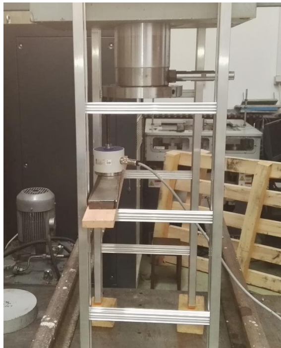
Слика 6. Тест оптерећења мердевина уз носач (50мм).
