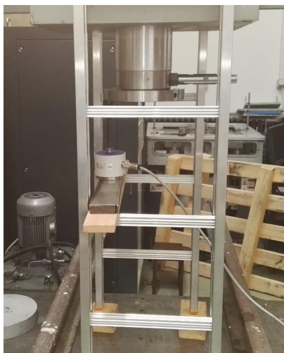
Слика 6. Тест оптерећења мердевина уз носач (50мм).
