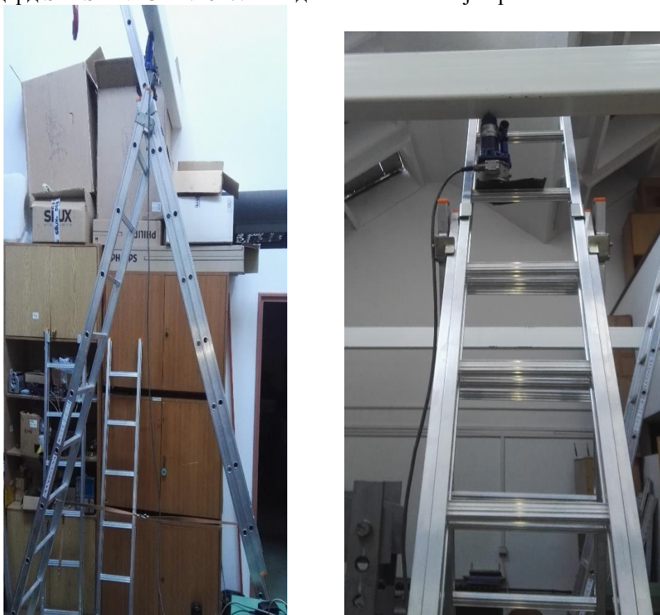
Слика 12 Испитивање троделних -подбочних мердевина ТАС Прамоал д.о.о. вертикалном силом у отвореном стању уз носач на 50mm
