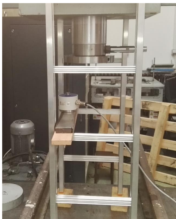
Слика 6. Тест оптерећења мердевина уз носач (50мм).
