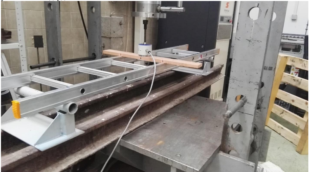
Слика 2 Конфигурација мерења носивости мердевина
