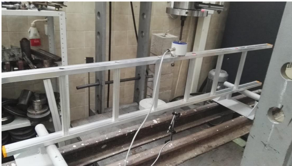
Слика 8. Мерење угиба у бочном правцу меревина
