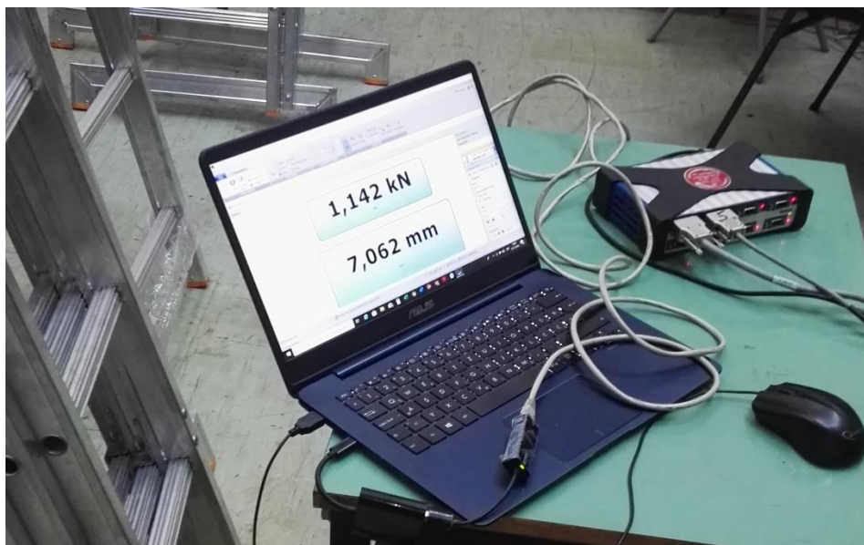
Слика 3. Мерна конфигурација и мерни рачунар
