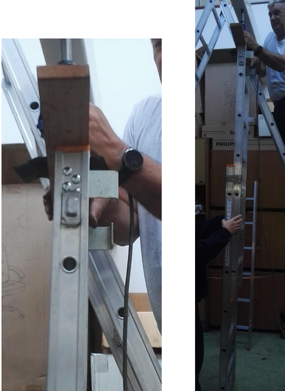
Слика 14 Испитивање осигурача дводелних мердевина за продужени положај
